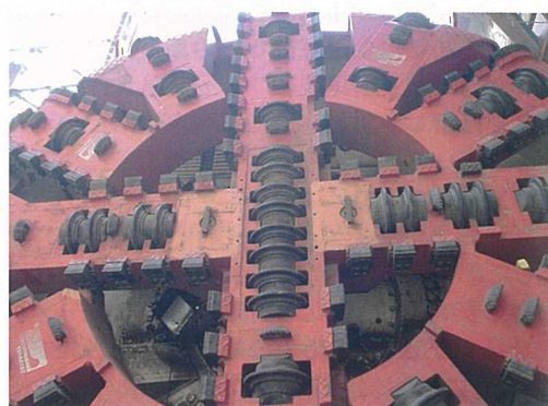
写真-3 シールドマシンカッターヘッド
