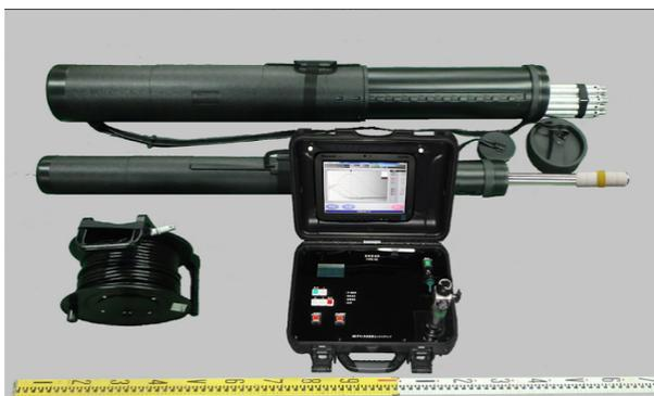
小孔径対応型流向流速計
