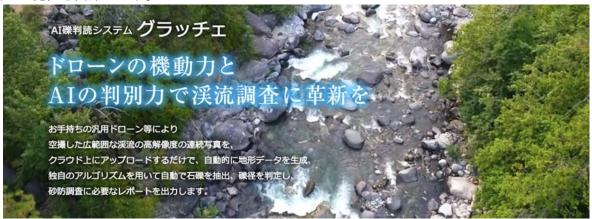
AI 礫判読システム「グラッチェ」は、ドローン等により空撮した広範囲な渓流の高解像度の連続写真を、クラウド上にアップロードするだけで、自動的にオルソ画像・DSM(高低差)画像・三次元点群データ等の地形データを生成。独自開発のアルゴリズムを用いて自動で石礫を抽出し、礫径を判定した上で、レポートを出力するシステムです。
