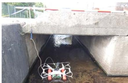
比較的規模が小さくかつ狭小空間である橋梁（みぞ型橋梁）の点検を実施する際、従来手法では点検が困難となっていました。今回製作した水面ドローンを活用することで容易かつスムーズに橋梁事前点検が行えます。
