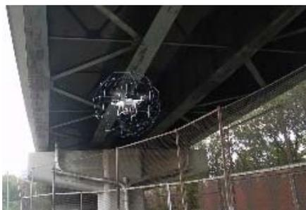
ドローンが様々な場面で活用されはじめるなか、同社では効果的で安全性に優れた橋梁事前点検に活用いただけるドローンを準備いたしました。従来型と異なり、比較的安価なドローン機器の採用により調査費用を削減し、カメラも全方位360°動画を採用したため、後から確認したい箇所を選びなおすことが可能な動画を提出することが可能です。
