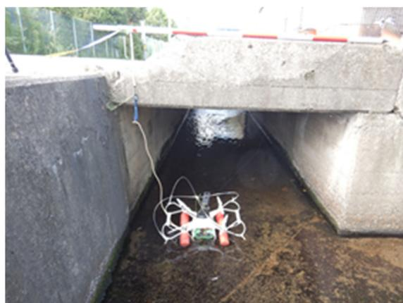
※研究開発の一例：水面ドローンによる橋梁点検
