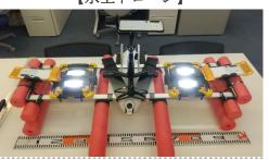
桟橋などの港湾施設を対象とし、水面ドローンと比較して撮影距離を保てるため、高精度カメラでの撮影を可能としたドローン。カメラにはジンバル(空間ぶれ補正装置)を装着し波浪の影響を低減。
