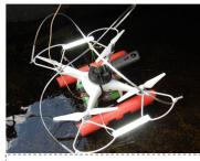
水路や溝橋など、狭い空間を、水面から360°カメラで撮影・点検するためのドローン。土砂だまりや浮遊物を浮上して回避しながら点検が続けられるのが特徴。
