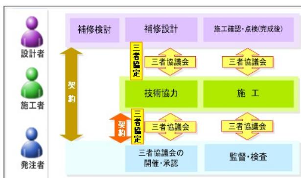
図-2 ECI 方式（田原本町仕様）の概念図
