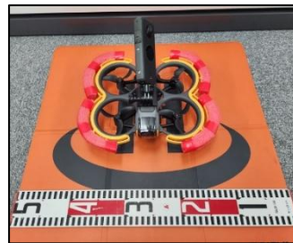
360°カメラ搭載 ミニドローン (鋼橋主桁間等撮影)
