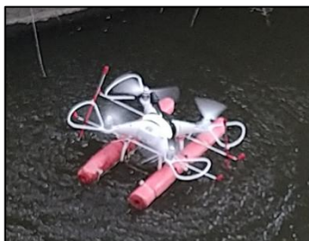
水面フローターと 360° カメラ搭載ド ローン
