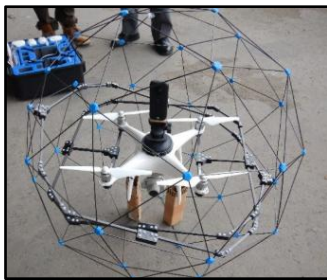
球体ガードと 360° カメラ搭載ドローン
