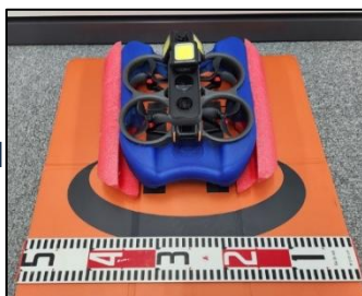
360° カメラ搭載 水上ミニドローン (溝橋・暗所等撮影)
