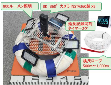
(1)下水道管路等点検水上カメラ (UAVを活用した点検手法)
