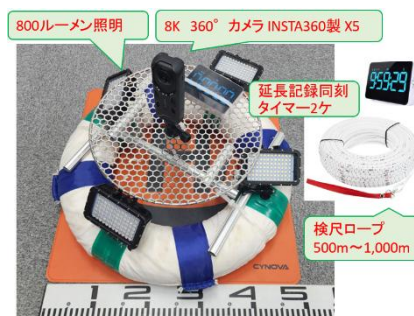
下水道管路等点検水上カメラ
