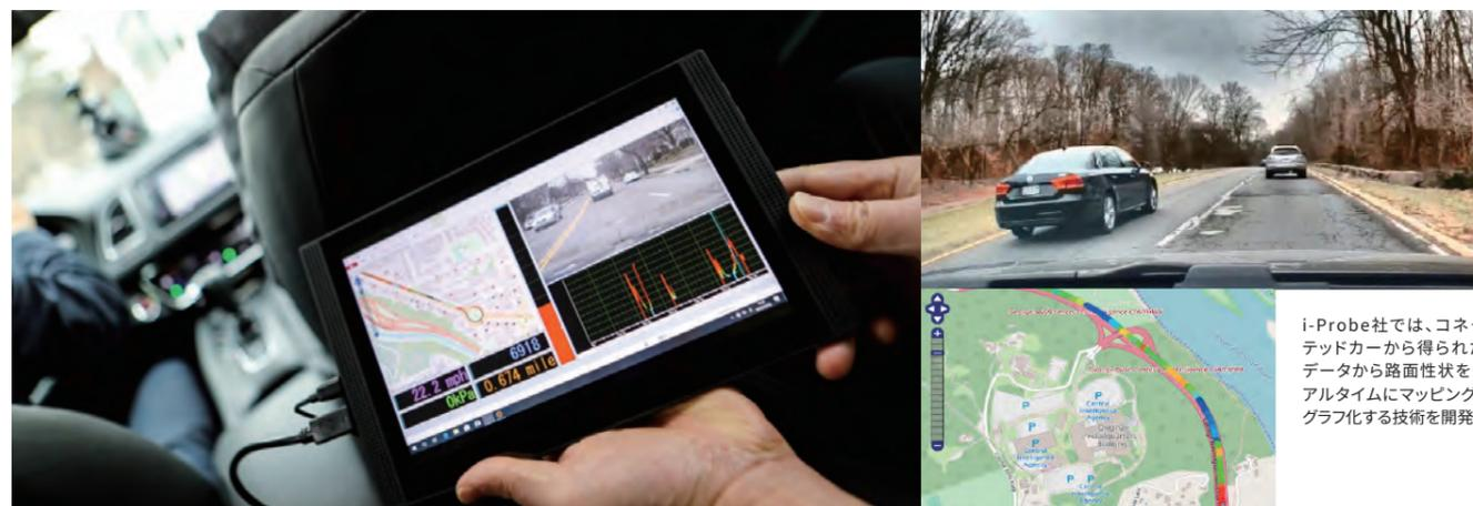
i-Probe社では、コネクテッドカーから得られたデータから路面性状をリアルタイムにマッピング、グラフ化する技術を開発
